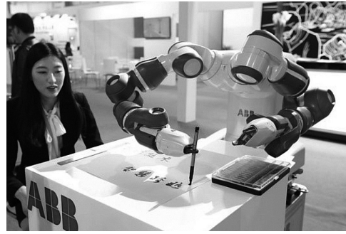
写真2 人間と協働する重電大手ABBの 双臂産業型ロボット「YuMi」
