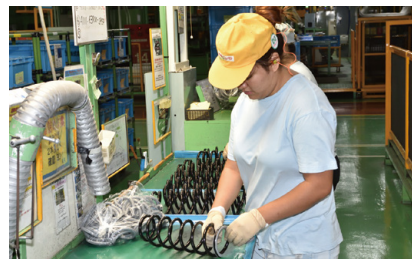
ばねにチューブを貼る作業
