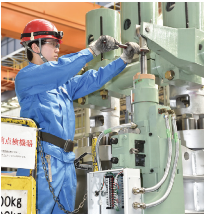
蒸気タービン弁の組立調整の様子
