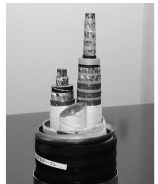
超電導ケーブルの構造
