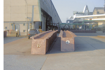
野外に整然と並べられた電機銅アノード
