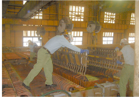
電線工場でのアノード挿入作業
