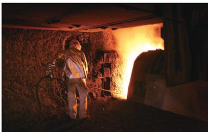
緊急時でも円滑に閉塞するための孔掃除
