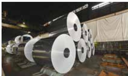
圧延工程の後 コイル状に巻き取られた製品
