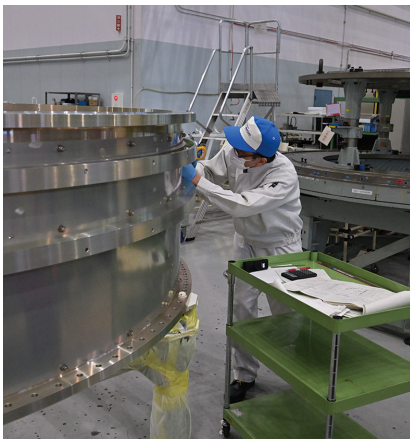
ロケット部品の検査の様子。最後は人の目で、入念に確認する。
