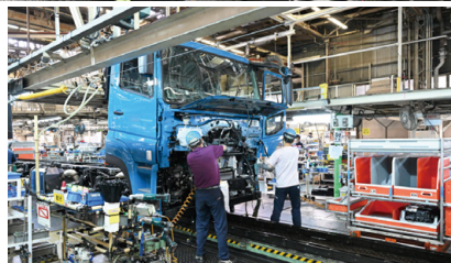
フロントガラスやドアが装着されたキャビン(運転席)の取り付け作業。スタッフ4人で行う
