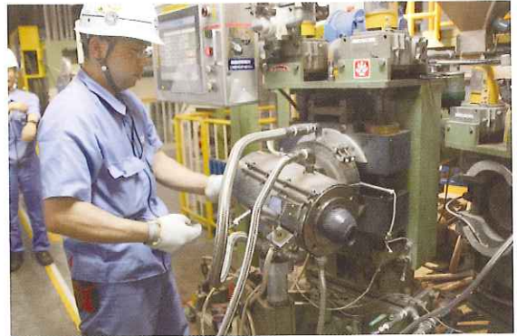
押出被覆工程で押出の段取りをする工程
