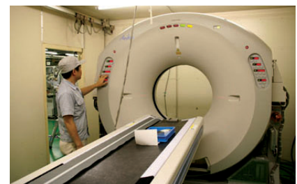
マルチスライスCT装置の最終検査
