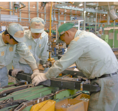
品質確認を交えた板ばねの作業指導
