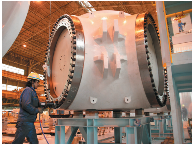
ナセルの頭部カプセルの組立作業
