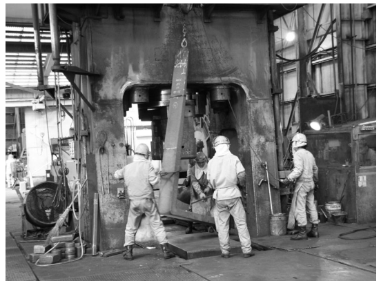
巨大なフォークリフトのツメの鍛造作業風景
