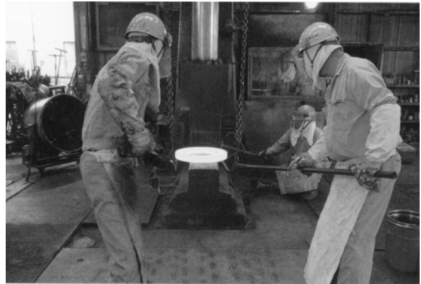
エアハンマーによる作業工程
