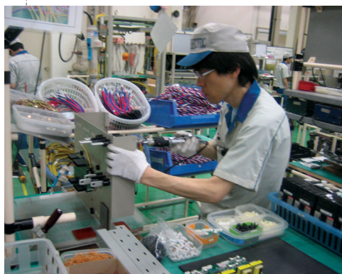
ブレーカブロックの組立工程
