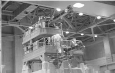
燃料交換機上で作業する作業員
