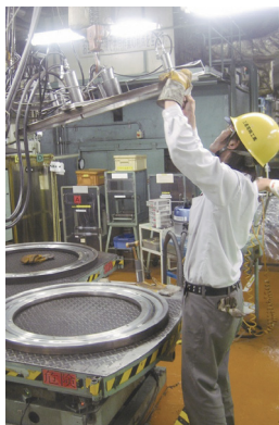
大径Oリングをプレス成形するために準備している様子
