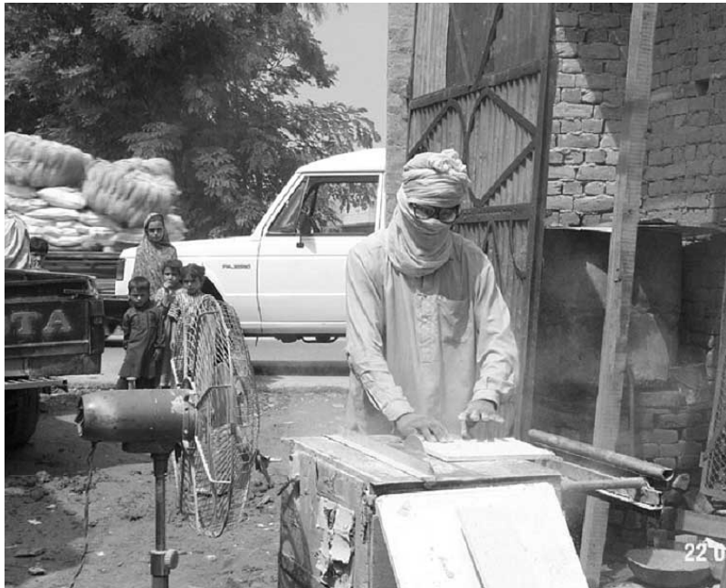
住宅地の大通りにあるマルダン市（パキスタン）のアスベスト断裁施設。そこら中にアスベスト粉塵が飛び散っている。扇風機には明確な目的がなく、回っていない。
